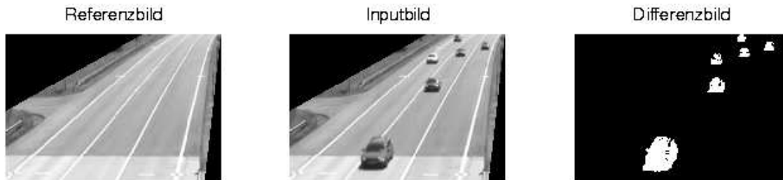
Abbildung 3.3: Beispiel für ein Differenzbild. Links ist das aus den drei Kanälen bestehende Referenzbild zu sehen, in der Mitte ein neues Inputbild. Rechter Hand befindet sich das resultierende Differenzbild.
